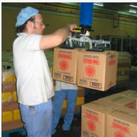
Одновременный подъем двух коробок одной вакуумной присоской. Такая комплектация подъемника ускоряет загрузку различных типов коробок одним манипулятором.
