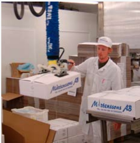
Пищевая промышленность использует вакуумные подъемники для перемещения коробок в холодильной установке. Типичное применение манипулятора коробок.
