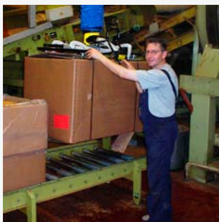
Перемещение очень тяжелых коробок весом до 100 кг в производстве и упаковке готовой продукции.
