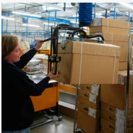
Гибкая удлиненная рукоятка имеет "сгибающийся локоть" для удобства погрузки коробок
