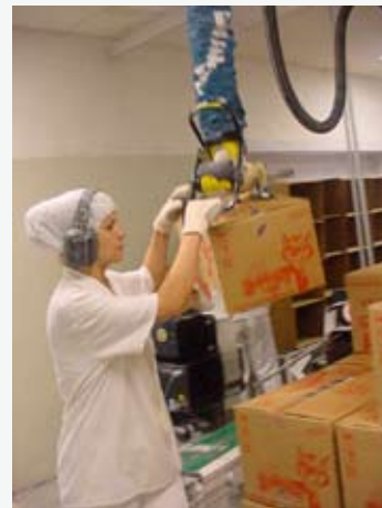
Пищевая промышленность использует вакуумные подъемники для перемещения коробок в холодильной установке. Типичное применение манипулятора коробок.
