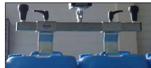
Подъём двух канистр с регулировкой хватных крюков.
